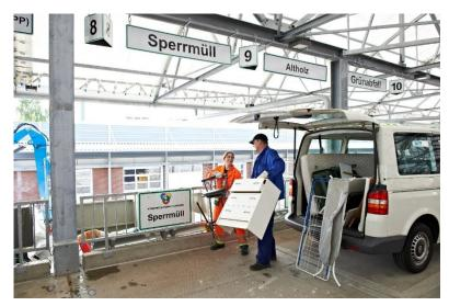
Ergonomische Abgabe von Abfällen: Eine Bauweise auf zwei Ebenen, wie sie bei den Recycling-Centern geplant ist, sorgt auch bei schweren Gegenständen für eine ergonomische und barrierefreie Befüllung der Container von oben. Foto: Stadtreinigung Hamburg
