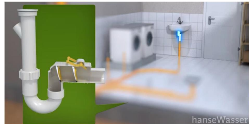
Mechanischer Rückstauverschluss als Einzelsicherung im Waschbecken – geschlossene Rückstauklappe
