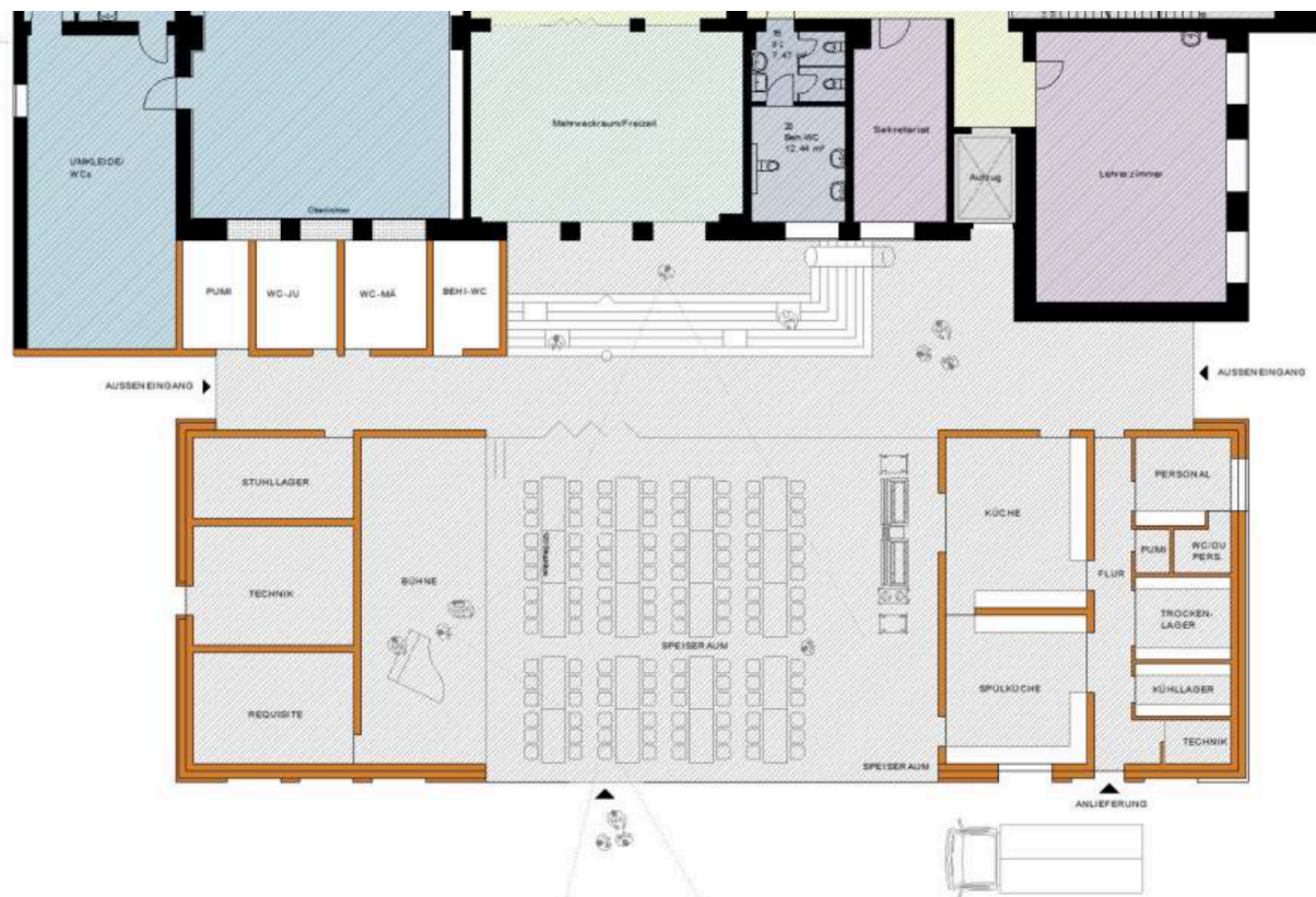
Abb.4: Mensa-Bau Anbau Bestandsgebäude rückseitig_möglicher Grundriss (Detail)
